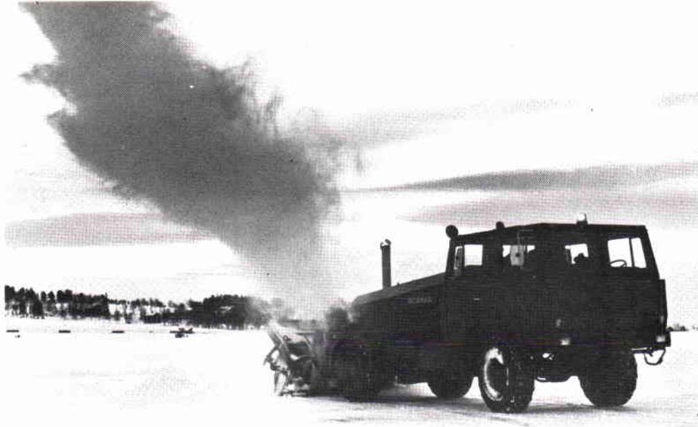
Snön slungas ut i ett moln som om brand uppstått i SAAB-SCANIA slungan. 35 ton snö per minut blåses undan på Frösön.
