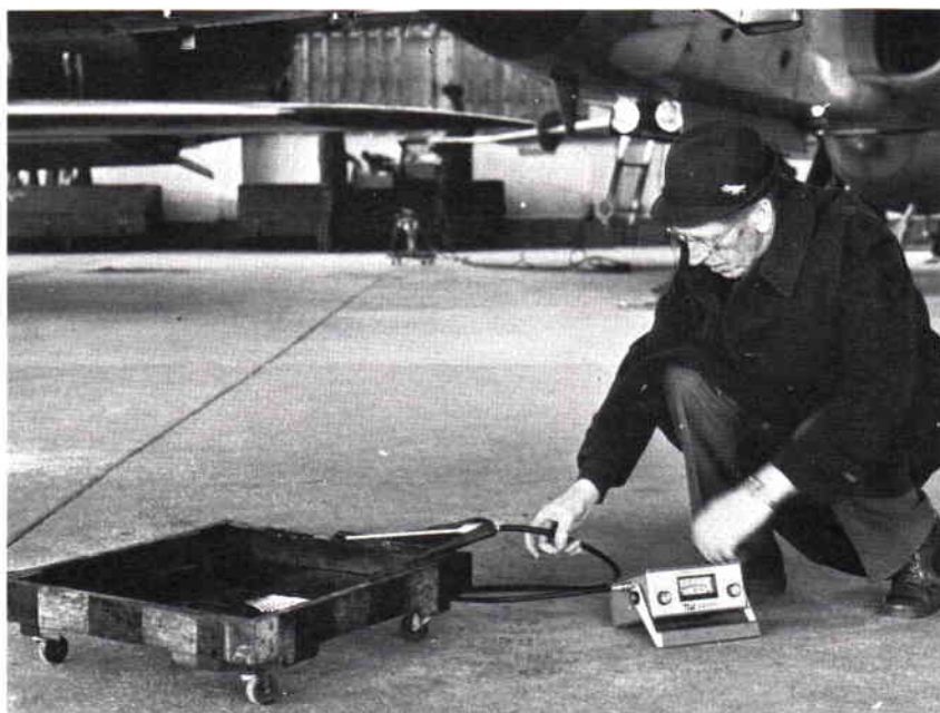
TLV-sniffen är ett nytt hjälpmedel för bl a skyddsombuden att undersöka koncentrationen av de farliga ångorna. Här provar Ki Berndt Magnusson, F 11, effektiviteten hos instrumentet t v s k halvmask.
